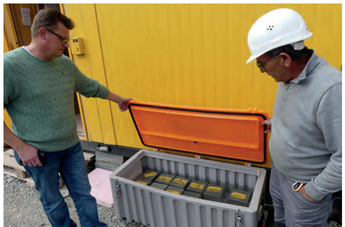
Von jedem Beton werden Proben gemacht, wie Fachbereichsleiter Johannes Kohle (links) und Polier Osman Bayrak zeigen.
