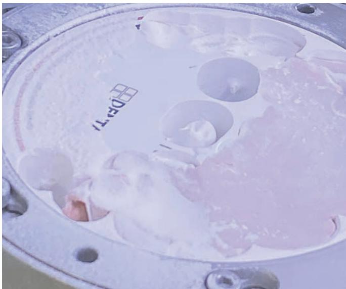
Hier erfolgt die Fräsbearbeitung eines Zahlenmodells aus einem kreideähnlichen Material.
