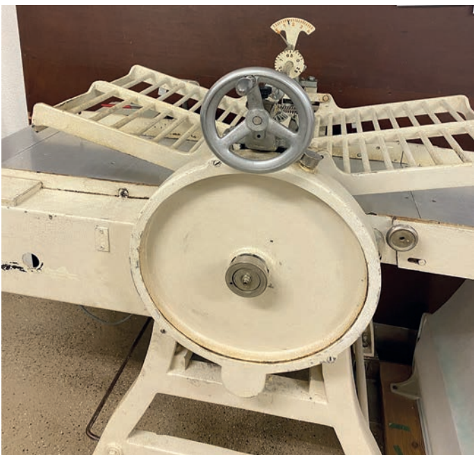
Auf der Teigausrollmaschine wird die Teigdicke für jede Nudelart oder für individuelle Kundenwünsche angepasst.
